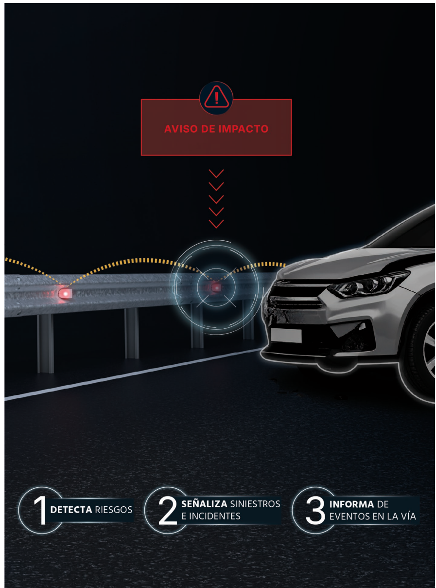
Ilustración 2 Esquema funcional de PlugSmart® Pro integrado con TRACE y la plataforma de las Autoridades de Control de tráfico MOTT/API.
